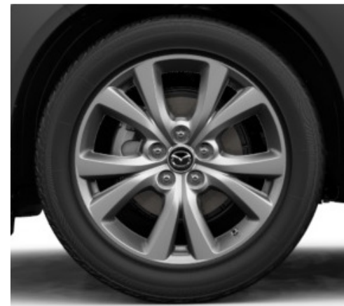
18-дюймовые легкосплавные колесные диски Silver Metallic (215/55R18)
