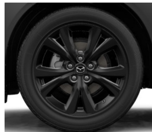
18-дюймовые легкосплавные колесные диски Black Metallic (215/55R18)
